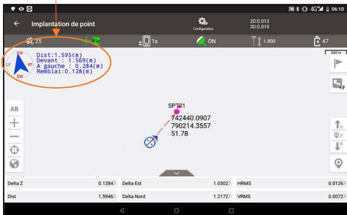
Lorsque la position du point à implanter est approchée de quelques centimètres, l'écran change comme indiqué ci-dessous. La position d'inclinaison de la canne GPS est également visible graphiquement.
